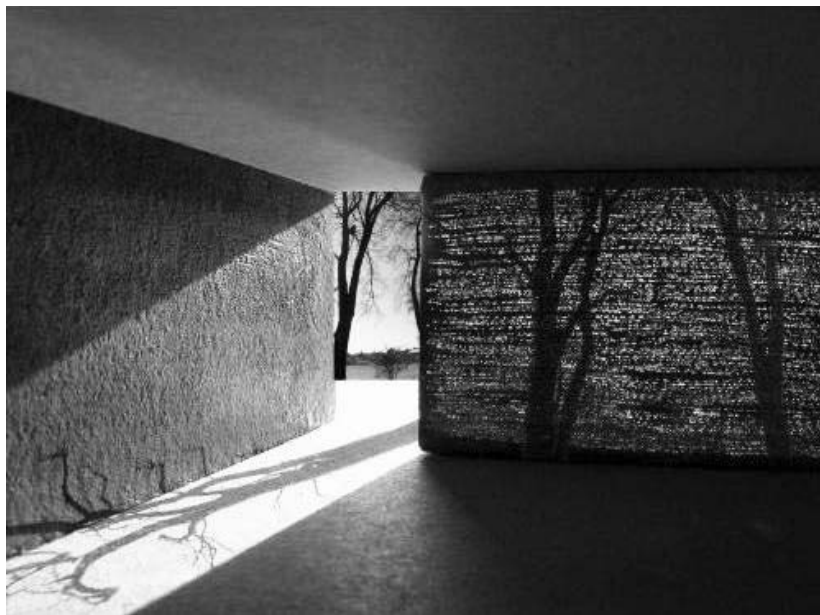
Рис. 9. Бетон, полученный с применением оптоволокна, выглядит прозрачным (разработки 2009–2010 гг.)
